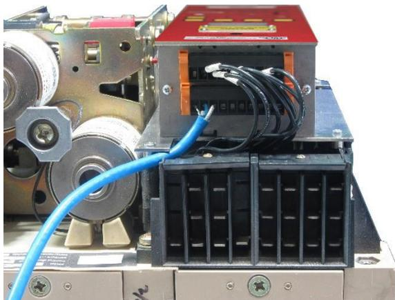
**Instalación del cable para comunicaciones (con la cubierta retirada) (AC-PRO-MP-II)**
