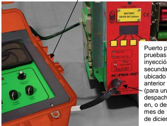
Puerto para pruebas de inyección secundaria ubicado en parte anterior del equipo (para unidades despachadas en, o después del mes de diciembre)
