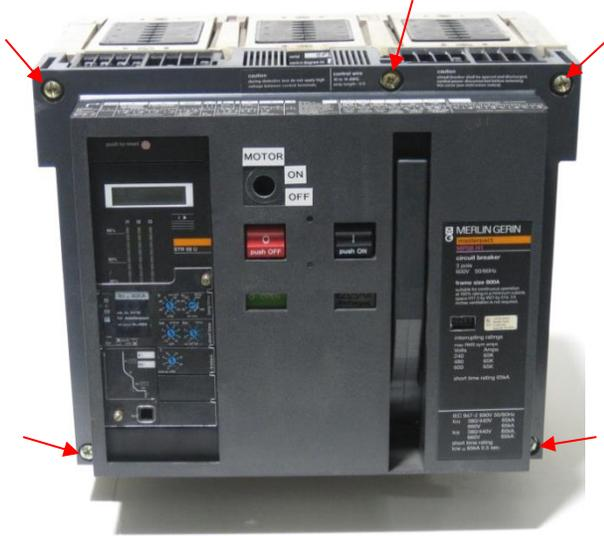
Retire los cinco (5) tornillos de la cubierta y luego la cubierta de enfrente.
